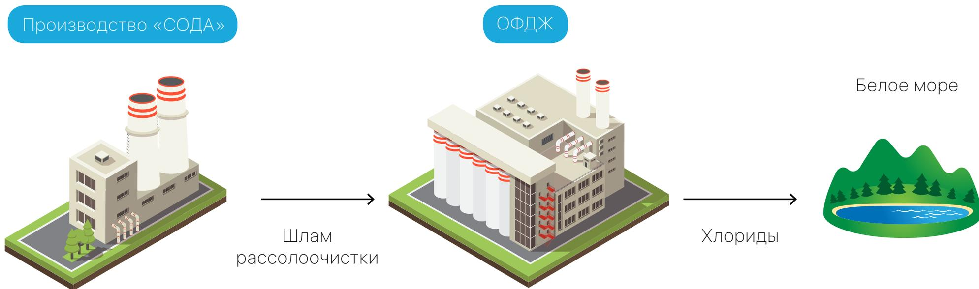
В настоящее время образующийся шлам цеха очистки рассола перекачивается по магистральным шламопроводам в цех фильтрации дистиллерной жидкости или напрямую в шламонакопитель «Белое море».
